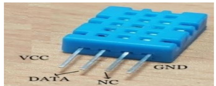
Fig. 4: DHT11Sensor
